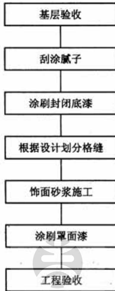
图 5.3.1 饰面砂浆施工工艺流程
